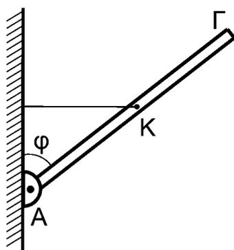
Λεπτή, άκαμπτη και ομογενής ράβδος ΑΓ μήκους  $l = 2\text{ m}$  και μάζας  $M = 5,6 \text{ kg}$  ισορροπεί με τη βοήθεια οριζόντιου μη εκτατού νήματος, που συνδέεται στο μέσο της, όπως φαίνεται στο σχήμα. Το άκρο Α της ράβδου συνδέεται με άρθρωση σε κατακόρυφο τοίχο.
