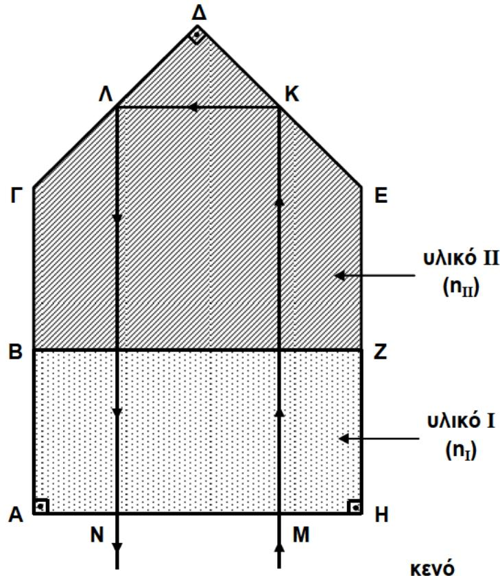
Μία μονοχρωματική ακτίνα φωτός με μήκος κύματος  $\lambda_0 = 400 \text{ nm}$  στο κενό διέρχεται από τη διάταξη, ακολουθώντας τη διαδρομή που δείχνει το σχήμα. Δίνεται ότι η ακτίνα εισέρχεται κάθετα στη διάταξη από την επιφάνεια AH στο σημείο M, ανακλάται πλήρως στα σημεία K και Λ των επιφανειών ΔE και ΔΓ, αντίστοιχα, και στη συνέχεια εξέρχεται από τη διάταξη κάθετα στην επιφάνεια AH στο σημείο N.
