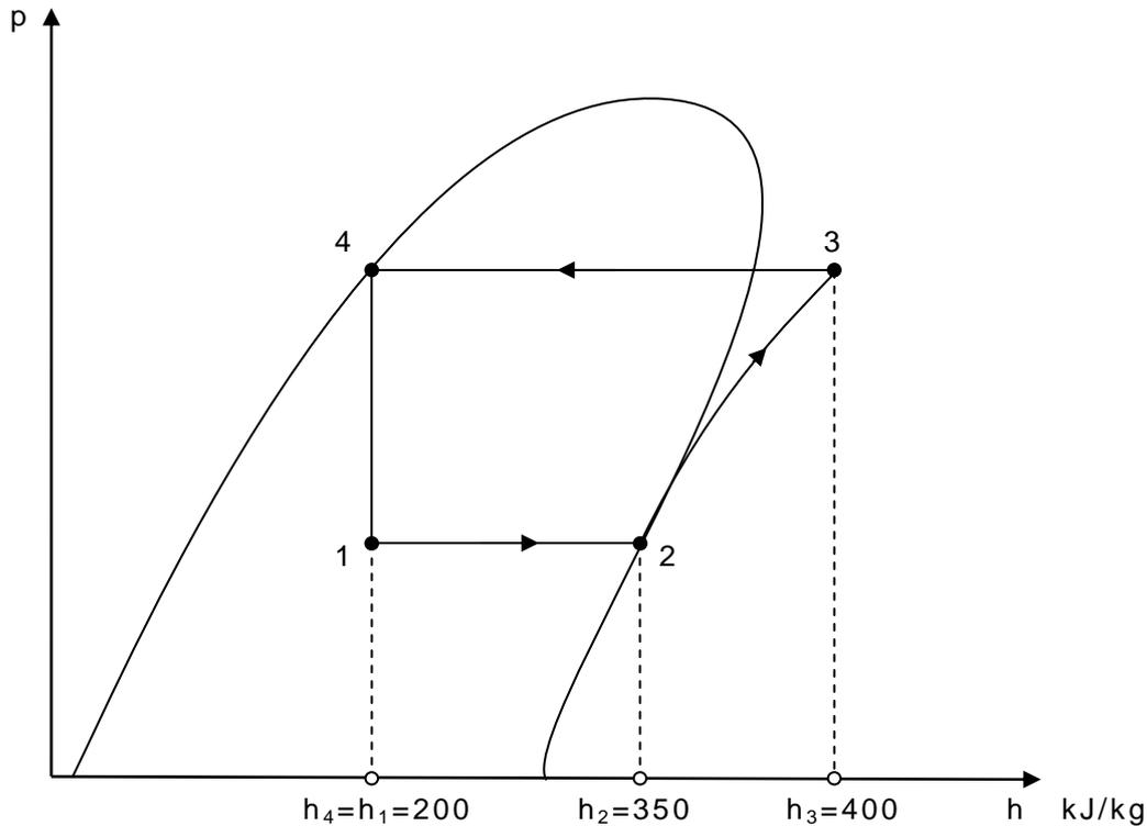
Η παροχή μάζας του ψυκτικού υγρού που κυκλοφορεί στην εγκατάσταση είναι  $\dot{m} = 0,05 \frac{\text{kg}}{\text{sec}}$ . Να υπολογίσετε:
