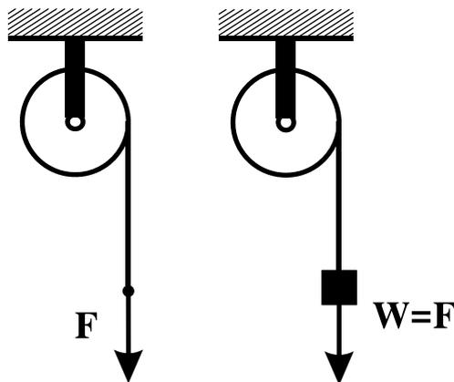
Όταν στο ελεύθερο άκρο του νήματος ασκούμε κατακόρυφη δύναμη με φορά προς τα κάτω μέτρου  $F$ , η τροχαλία αποκτά γωνιακή επιτάχυνση μέτρου  $\alpha_{\gamma\omega\nu,1}$  ενώ, όταν κρεμάμε στο ελεύθερο άκρο του νήματος σώμα βάρους  $w = F$  η τροχαλία αποκτά γωνιακή επιτάχυνση  $\alpha_{\gamma\omega\nu,2}$ . Ισχύει:
