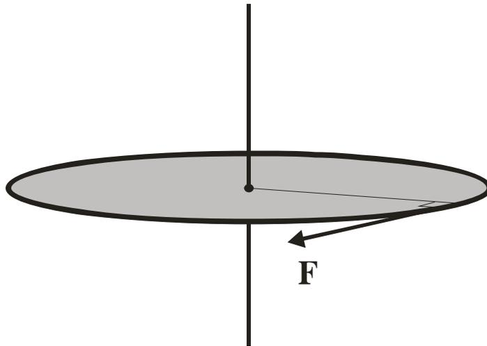
Ο δίσκος αρχικά είναι ακίνητος. Κάποια στιγμή  $t_0 = 0$ , ασκείται σε σημείο της περιφέρειας του δίσκου δύναμη σταθερού μέτρου  $F = 10 \text{ N}$ , συνεχώς εφαπτόμενη σε αυτόν.
