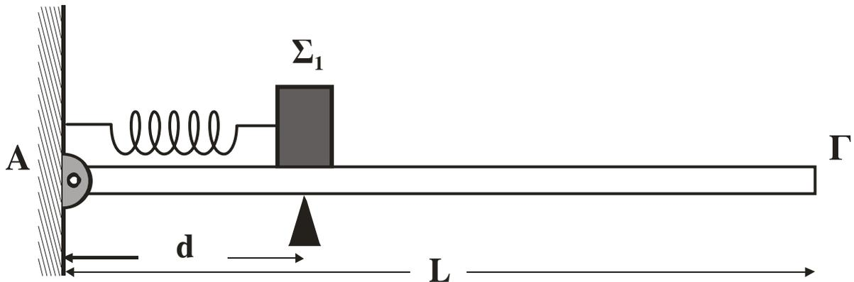
Το κέντρο μάζας του σώματος  $\Sigma_1$  βρίσκεται σε απόσταση  $d$  από τον τοίχο. Στη συνέχεια, ασκούμε στο σώμα  $\Sigma_1$  σταθερή οριζόντια δύναμη μέτρου  $F = 40\text{ N}$  με κατεύθυνση προς το άλλο άκρο  $\Gamma$  της σανίδας. Όταν το σώμα  $\Sigma_1$  διανύσει απόσταση  $s = 5\text{ cm}$ , η δύναμη παύει να ασκείται στο σώμα και, στη συνέχεια, το σώμα εκτελεί απλή αρμονική ταλάντωση.
