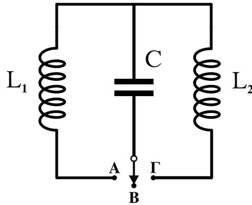
Τη χρονική στιγμή  $t_0 = 0$  ο διακόπτης τίθεται στη θέση Α και αρχίζει να εκτελείται ηλεκτρική ταλάντωση με περίοδο  $T$ . Τη χρονική στιγμή  $t_1 = \frac{5T}{8}$  ο διακόπτης μεταφέρεται στη θέση Γ. Αν  $I_{\max,1}$  είναι το μέγιστο ρεύμα στο κύκλωμα  $L_1C$  και  $I_{\max,2}$  το μέγιστο ρεύμα στο κύκλωμα  $L_2C$ , τότε:
